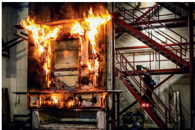
Ståluafhæng på facaden er med til at forhindre brandspredning.
